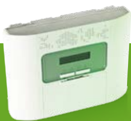
PowerMaster-30 64 зонная контрольная панель
